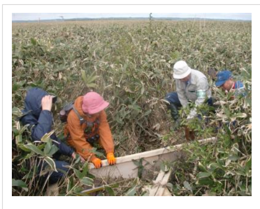
写真 -1 三角堰設置作業(2013 年 6 月 3 日)
